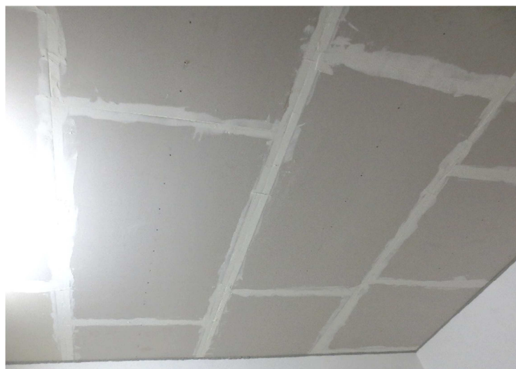
Abbildung A 2.6: Unterdecke (Prüfsituation)
